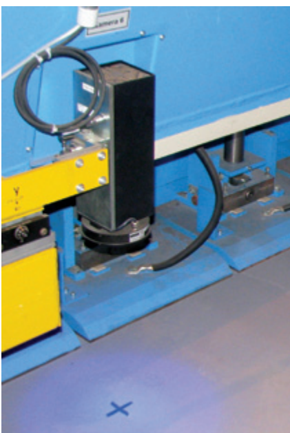
Markenerkennung an der Schweißstation
