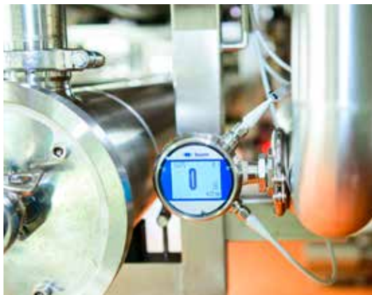
En optimisant le process NEP, on peut économiser jusqu'à 100 000 litres d'eau par jour grâce au capteur de conductivité CombiLyz AFI de Baumer.
