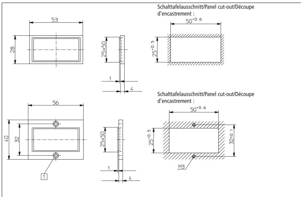
Senkung Af3, DIN 74/Countersinking Af3, DIN 74/Fraiseure Af3, DIN 74
